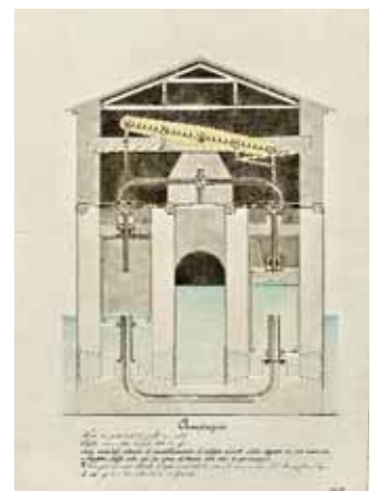
Giuseppe Jappelli, sezione di macchina idrovora
