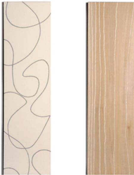
Pannelli “Lineamenti” : l'applicazione concettuale del decoro su un pannello in MDF (bianco), dove un semplice scarabocchio ingrandito e disegnato con pantografo poi riempito con silicone grigio ne diventa il decoro. Sul pannello in noce americana, il decoro invece è dettato dalle stesse venature del legno che sono state scavate e riempite con silicone bianco.
